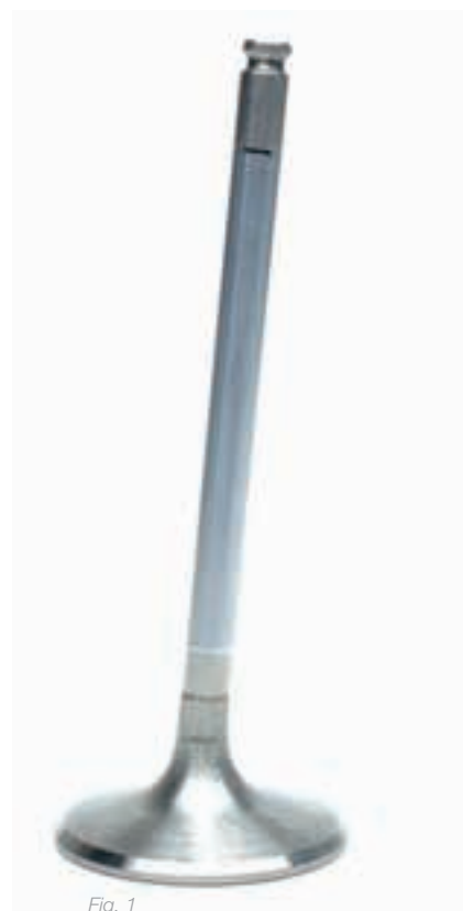
Fig. 1 Bent valve stem
